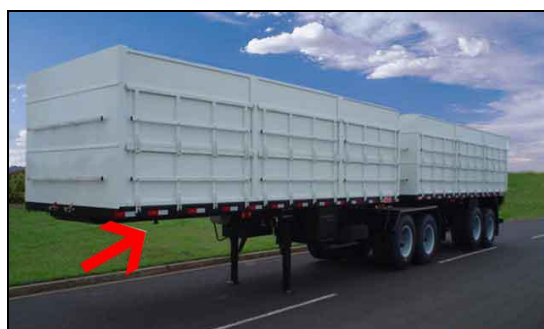
Figura 6: Semi Reboque Bi-trem com Pino Rei
