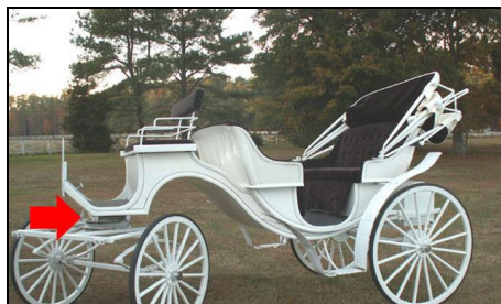
Figura 8: Quinta Roda utilizada em carro antigo
